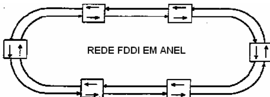
Fig 2.10 Uma rede PDDI com fibras ópticas fazendo a conexão de seis computadores. As setas indicam a direção do tráfego nas fibras e nos computadores conectados entre si.
